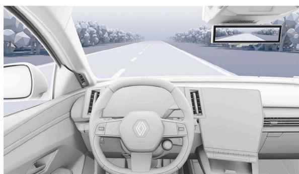
**rétrovision par caméra** Une caméra placée à l'arrière du toit est associée à un système de rétrovision par caméra. Le rétroviseur intérieur offre une vue dégagée, même avec des passagers de grande taille à l'arrière.
